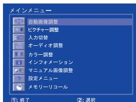
② 調整したいアイコンがあるメニュー項目を選択し、②ボタンを押します。▲/▼ボタンで調整する項目を選択します。
