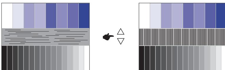
⑦ 画面調整プログラムの「位置」を選択し、調整メニューの垂直位置、水平位置にてクロスハッチパターンの上下左右枠が表示領域に入るよう調整します。
