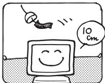
通風孔をふさぐと内部に熱がこもり、火災の原因となることがあります。風通しをよくするために、モニターは周囲から10cm以上離して置いてください。チルトスタンドを取り外して使用するときも、モニター背面の通風孔をふさがないように十分なスペースを確保してください。
