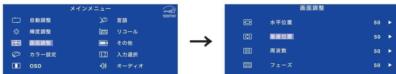
調整画面が表示されますので、◀/▶ ボタンでお好みの画面に調整します。最後にEXITボタンを押して終了し、設定の記憶をします。
