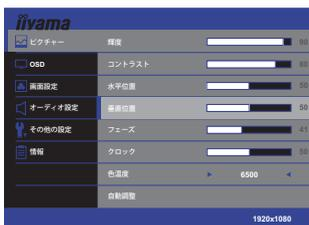
調整画面が表示されますので、◀/▶ ボタンでお好みの画面に調整します。最後に AUTO ボタンを押して終了し、設定の記憶をします。
