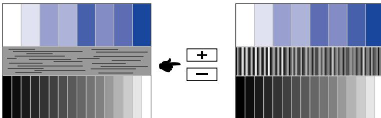
⑦ 画面調整プログラムの「位置」を選択し、調整メニューの垂直ポジション、水平ポジションにてクロスハッチパターンの上下左右枠が表示領域に入るよう調整します。
