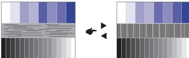
⑦ 画面調整プログラムの「位置」を選択し、調整メニューの垂直位置、水平位置にてクロスハッチパターンの上下左右枠が表示領域に入るよう調整します。
