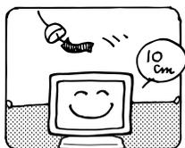
通風孔をふさぐと内部に熱がこもり、火災の原因となることがあります。風通しをよくするために、モニターは周囲から10cm以上離して置いてください。チルトスタンドを取り外して使用するときも、モニター背面の通風孔をふさがないように十分なスペースを確保してください。
