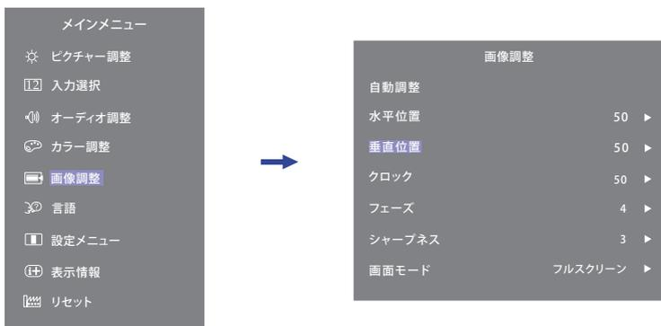
調整画面が表示されますので、◀/▶ ボタンでお好みの画面に調整します。
