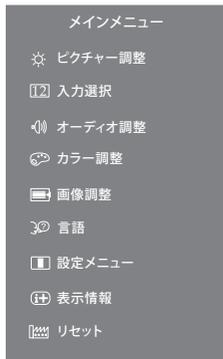
例えば垂直位置を調整したいときは、まずメニュー項目の画像調整を選択し、ENTER ボタンを押します。次に◀/▶ ボタンで垂直位置を選択し、ENTER ボタンを押します。
