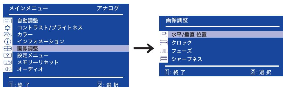
調整画面が表示されますので、▲/▼ ボタンでお好みの画面に調整します。最後にメニューボタンを押して終了し、設定の記憶をします。
