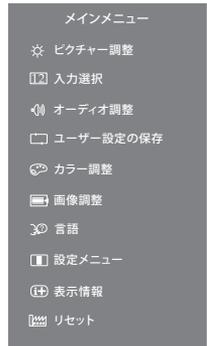
例えば OSD の垂直位置を調整したいときは、まずメニュー項目の設定メニューを選択し、ENTER ボタンを押します。次に◀/▶ ボタンで OSD 位置を選択し、ENTER ボタンを押します。
