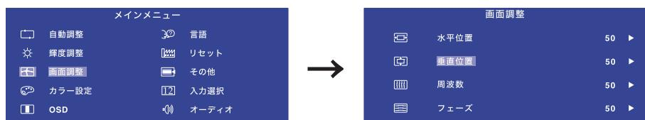
調整画面が表示されますので、◀/▶ ボタンでお好みの画面に調整します。
