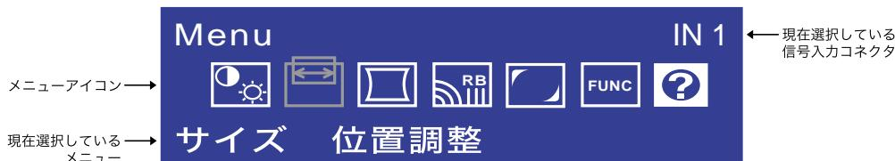
③ サブメニューで
