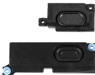
従来製品（上側）と比較して、容積比で約5倍に大型化した内蔵スピーカーユニット（下側）
