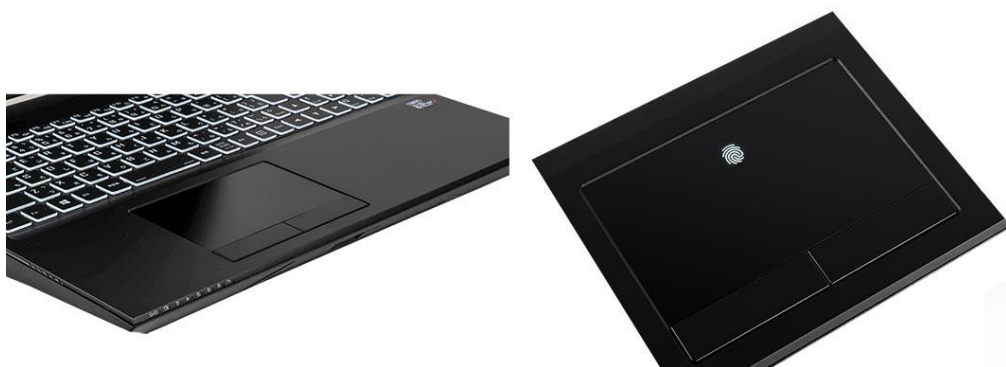
指紋認証センサーを使用するときのみ、タッチパッドにマークが浮かび上がります
