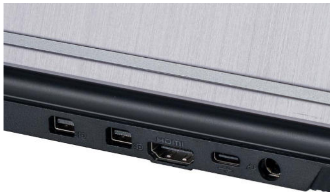
左から mini DisplayPort x2/HDMI/USB3.0 type-C/電源 ポート
