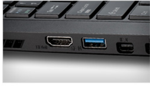
HDMIとUSB3.0の隣接配置
