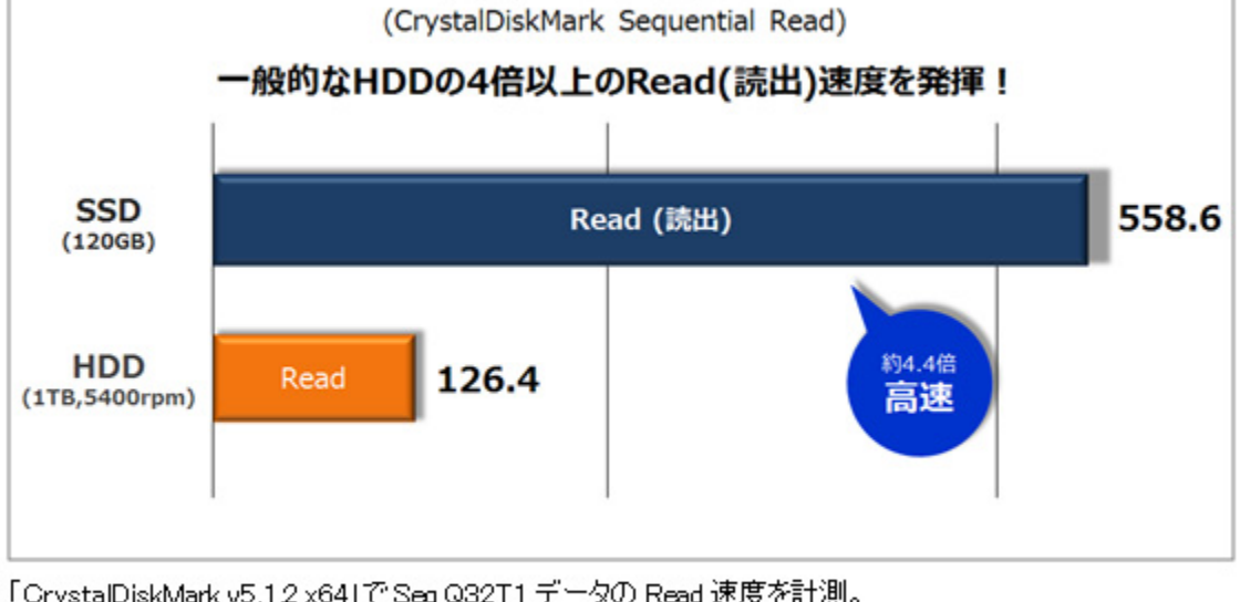
「CrystalDiskMark v5.1.2 x64」でSeq Q32T1 データの Read 速度を計測。 m-Book B501E の標準 120GB SSD と 1TB ハードディスク構成で比較。スコアは自社測定による参考値です。 使用するデバイスや環境、その他の要因によって測定結果は変動します。
