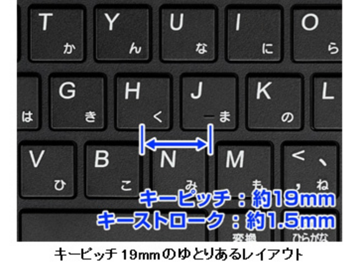
約4.8mm せり上がる キーピッチ: 約19mm キーストローク: 約1.5mm
