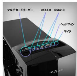
フロント I/O ポートは利便性を考慮してケース天面に設置し、パソコンデスク下に本機を設置した場合でも、容易なアクセスが可能です。USB3.0を2つ、USB2.0を2つ、マイク・ヘッドフォン端子、マルチカードリーダーといった豊富な I/O ポートを設けています。
