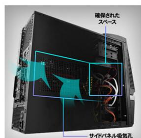
ゲーム用途に特化した内部構造となる独自の「NEXTGEARシャーシ」を採用。デッドスペースの要因となりがちな、マザーボードが持つポート数よりも多い分のハードディスクゲージを大胆にカットし、大型のグラフィックスカードを余裕を持って搭載可能とするスペースを確保。フロントに搭載された冷却FANと、グラフィックスカード搭載箇所へ直接吸気するように設計されたサイドパネルにより、新鮮な空気をグラフィックスカードに直接送り込むことができ、熱量の高いグラフィックスカードも安心して搭載することができます。
