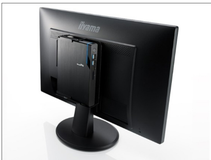
付属の VESA マウントでディスプレイの背面に装着可能。一体型 PC のようにデスクスペースを広く活用できる
