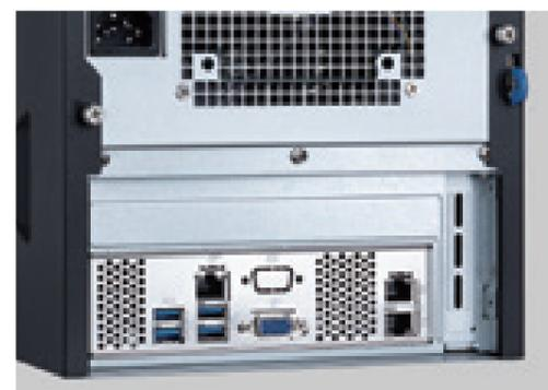
各種サーバー機能の搭載・開発時に重宝する2つのギガビット対応LAN端子、外部記憶装置との接続に便利なUSB3.0端子、組み込みボードなどの利用に便利なPCIExpress×16スロットなど、ハードウェア単体としても優れた機能性を備えています。<sup>※1</sup>
